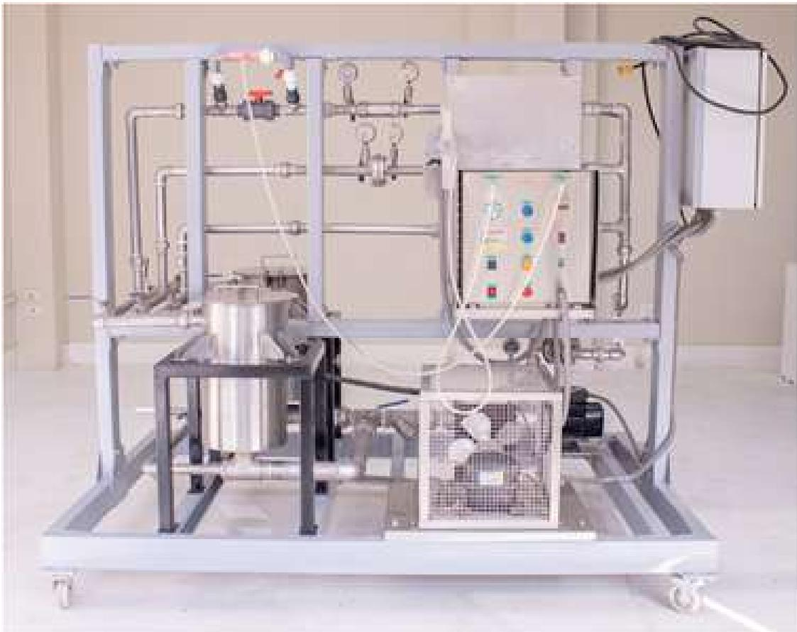
Este fenómeno físico es potenciado con ozono que aumenta significativamente la acción de las microburbujas. El dispositivo que está diseñado a escala prototipo, puede tratar 20 litros de efluentes en una hora y es de fácil traslado al ser un producto movable.
